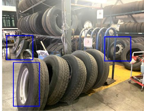
Photo 13 : Pneus montés sur jantes et gonflés - entreposage non sécuritaire - risque d'éclatement et de projection de la jante
