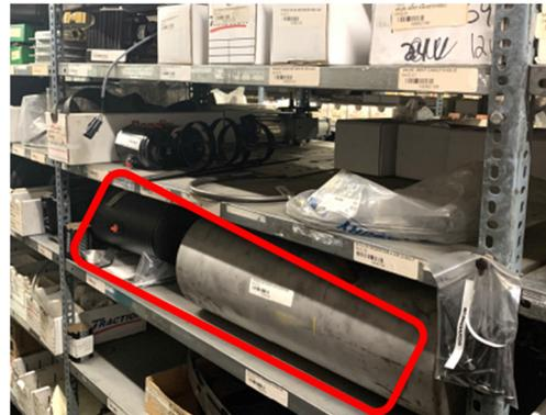
Photo 15 : Réservoir d'expansion n'est pas avec le bouchon associé
