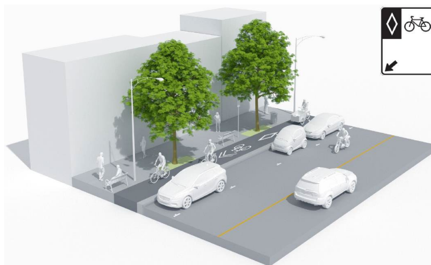
Figure 52 : Piste cyclable unidirectionnelle au niveau du trottoir
