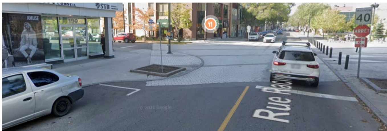
Figure 27 : Dos d'âne allongé, rue Majeau, L'Épiphanie
